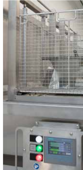
ALMAs neue UCV-Reinigungsanlage: Bereits beim Einschleusen werden die Bauteile mit einem Badge zur Kennzeichnung und Dokumentierung versehen.
