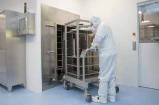
Der Vakuumofen für thermische Behandlungen
