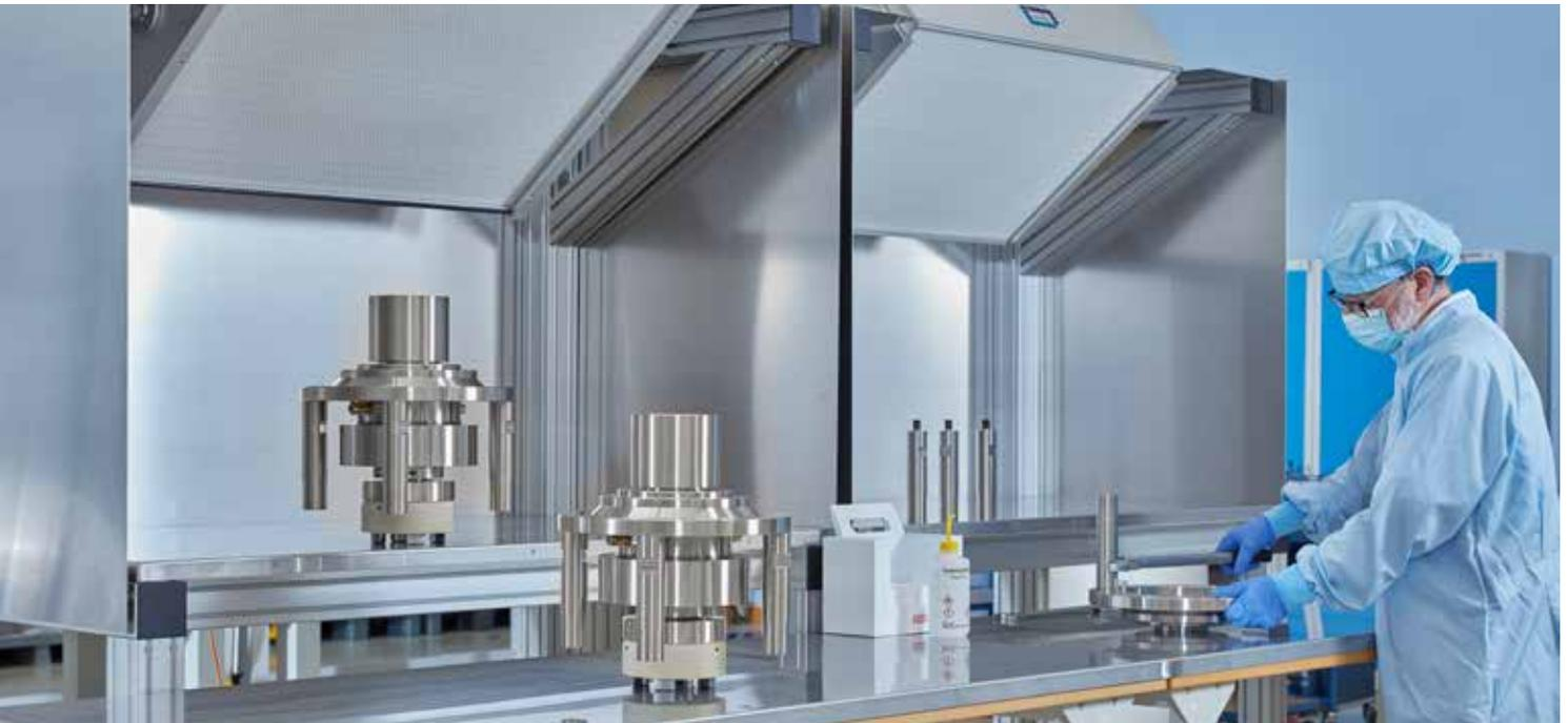
Unsere Hybrid-Montage wird in einem Sauberraum unter Flow-Boxen durchgeführt, die mit leistungsstarken Lüfter-Filter-Modulen der Reinraum-ISO-Klasse 6 ausgerüstet sind, um Verunreinigungen durch Partikel zu minimieren. Je nach Montageanforderung können die flexibel verfahrbaren Flow-Boxen z.B. parallel oder in Reihe angeordnet werden – für einen ergonomischen Montageaufbau.
