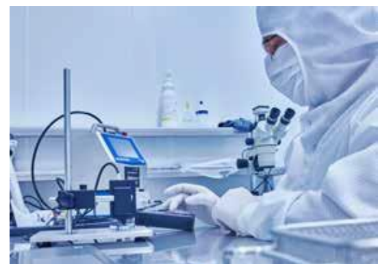
Sichtprüfungen hinsichtlich der Partikelkontamination können mit Weiß- oder UV-Licht sowie mittels Cleanospector oder Lichtmikroskop erfolgen.
