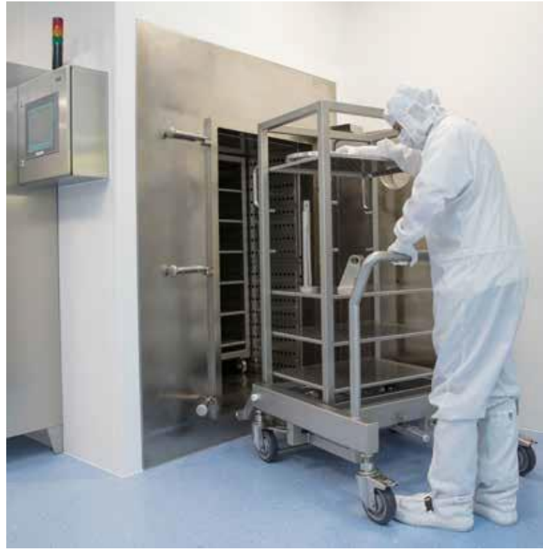
Die Trockenreinigung durch Ausheizen im Vakuumofen sorgt für hochreine Oberflächen.
