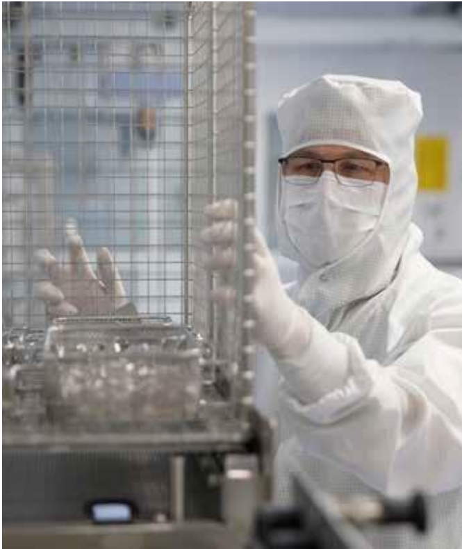
Gereinigte Bauteile werden zur Montage in den ISO-5-Reinraum geschleust.
