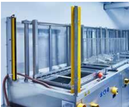
Nassreinigung im Klasse-6-Reinraum: Bereits beim Einschleusen werden die Bauteile mit einem Badge zur Kennzeichnung und Dokumentierung versehen.
