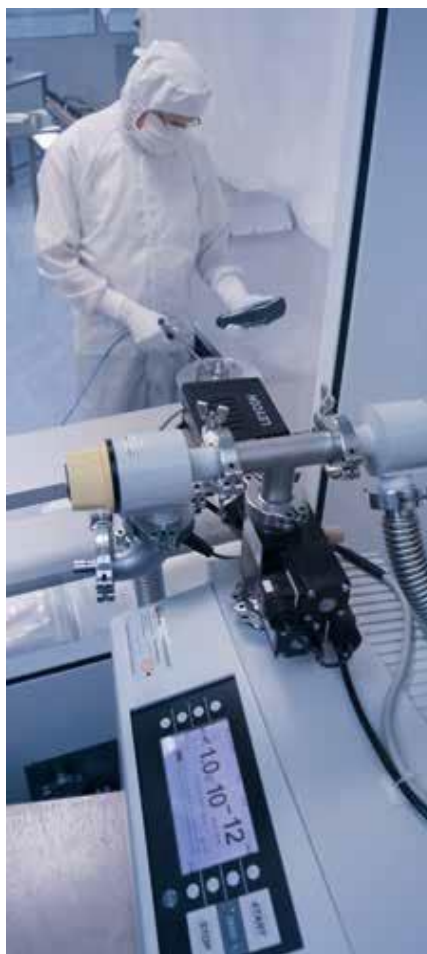
He-Dichtheitsprüfungen von Baugruppen oder Endprodukten können durch intelligente Anordnung des Lecktest-Equipments vom Grauraum aus auch im Reinraum erfolgen, so dass Verunreinigungen durch den Prüfaufbau zuverlässig ausgeschlossen sind.
