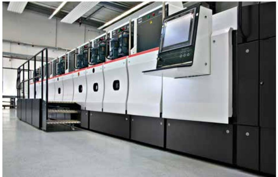
PIA | nova® – modulare Anlagenplattform zur Beschichtung von Glas für die Dünnschicht-Photovoltaik.
