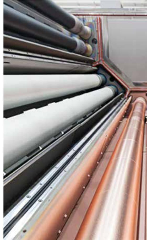
Auch in den Sputtering-Systemen vom Typ FlexBlue kommen ALMA-Drehdurchführungen mit Magnetfluiddichtung zum Einsatz.
