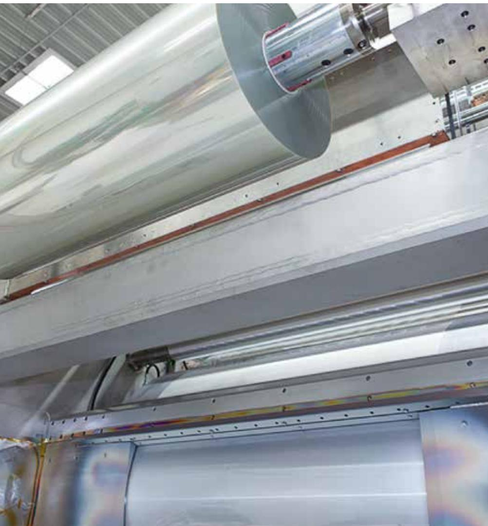
Mit FlexBlue Sputtering-Systemen von SCHMID können im Vakuum verschiedene metallische oder nichtmetallische Schichten auf flexible Substrate von Rolle zu Rolle hochpräzise aufgebracht werden.
