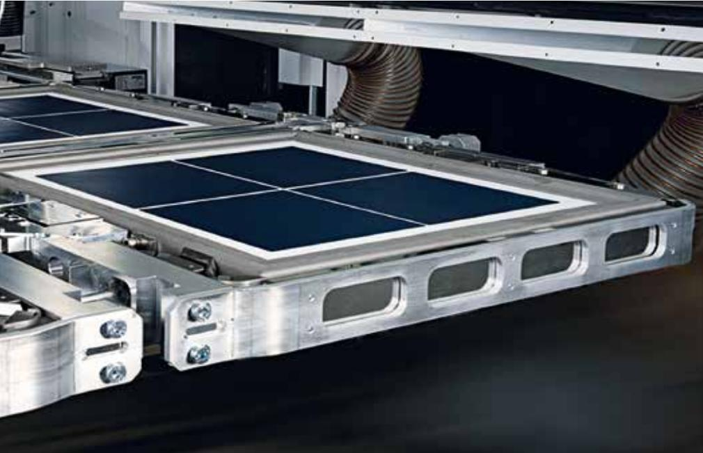
Die PECVD-Anlage VCS 1200 beschichtet in einer plasmaunterstützten chemischen Gasphasenabscheidung die Vorder- und Rückseite von Siliziumwafern. (Foto: MANZ AG, Corporate Communications)
